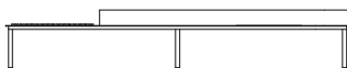
BANCO DECK 220 X 70 X 37cm (LxPxA) Deck com largura de 60cm 01 unidade de assento (L=160x70cm)
